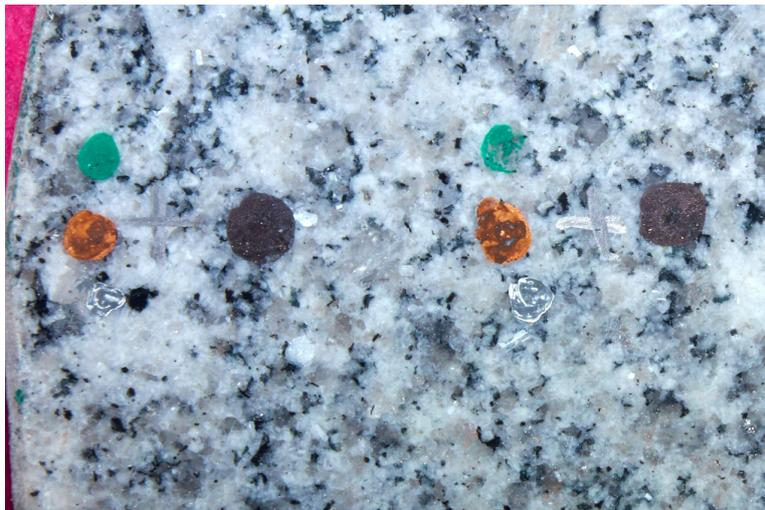
Abbildung 1.7: Markierungspunkte nach kurzem Kontrollschliff
