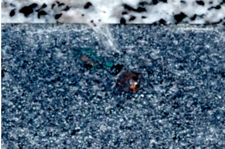
Abbildung 1.10: Tuscherpunkte nach der Prüfung, Detail bei Ziffer 1, Punkte weitgehend verschwunden
