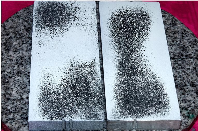
Abbildung 1.12: flächenhafte Tuschierung nach der Prüfung
