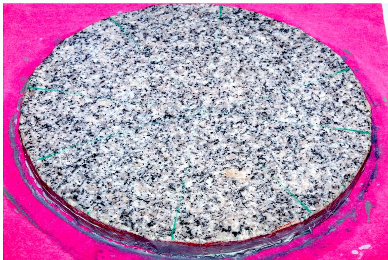
Abbildung 1.3: Sternlinien, fortgesetzter Kontrollschliff; Haarlineal: Platte fraglich konvex; Tuschieren: tatsächlich konvex
